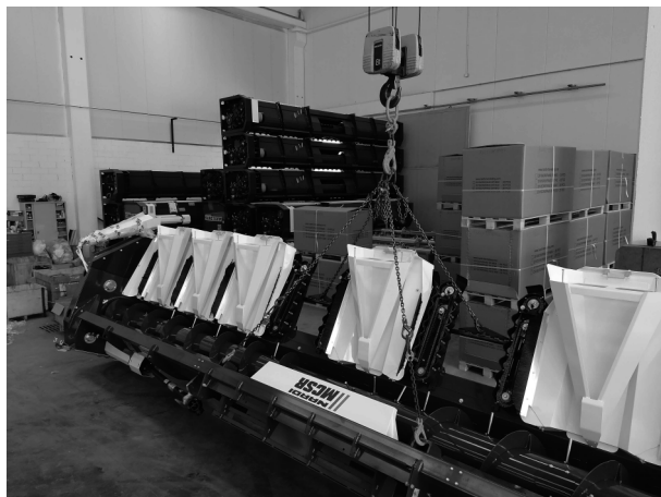
FIG. 02 - 05 - INIZIARE IL RIBALTAMENTO SOLLEVANDO IL GANCIO DELLA GRU IN MODO LENTO E CONTINUO E MANTENENDO IL PIU' POSSIBILE SULLA VERTICALE.
