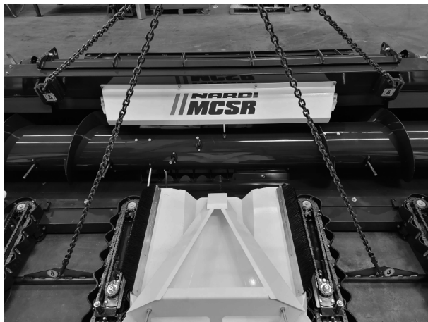
FIG. 01 - 02 - AGGANCIARE 4 TIRI CATENE NEGLI APPOSTI OCCHIELLI DI SOLLEVAMENTO. VERIFICARE LA PORTATA DEI TIRI CATENA CON IL PESO DELLA BARRA.
