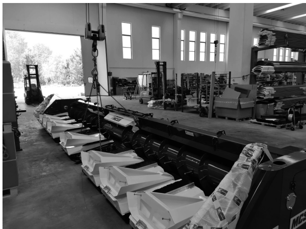
FIG. 01 - 02 - AGGANCIARE 4 TIRI CATENE NEGLI APPOSTI OCCHIELLI DI SOLLEVAMENTO. VERIFICARE LA PORTATA DEI TIRI CATENA CON IL PESO DELLA BARRA.
