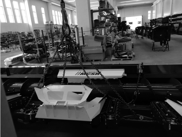
FIG. 01 - AGGANCIARE 4 TIRI CATENE NEGLI APPOSITI OCCHIELLI DI SOLLEVAMENTO. ALLUNGARE LE CATENE VICINE ALLA COCLEA DI CIRCA 70 CM IN PIU' RISPETTO LE CATENE TRA I GRUPPI FILA. VERIFICARE LA PORTATA DEI TIRI CATENA CON IL PESO DELLA BARRA. FIG. 01 - HOOK 4 CHAINS ON THE LIFTING HOLES. EXTEND THE CHAINS NEAR THE AUGER BY APPROXIMATELY 70 CM MORE THAN THE CHAINS BETWEEN GROUPS. CHECK THE LOAD CAPACITY OF THE CHAINS WITH THE WEIGHT OF THE HEADER.
