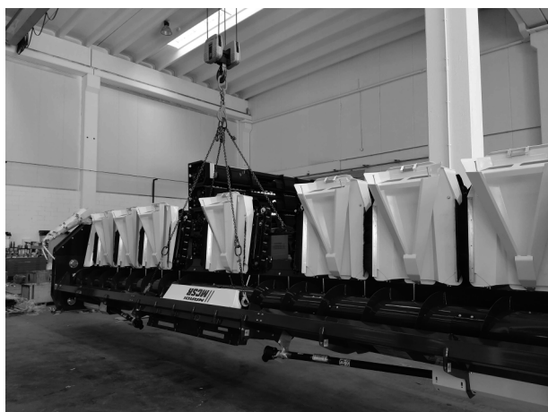
FIG. 03 - LA BARRA E' PRONTA PER ESSERE SOLLEVATA. FIG. 03 - HEADER IS READY TO BE LIFTED.
