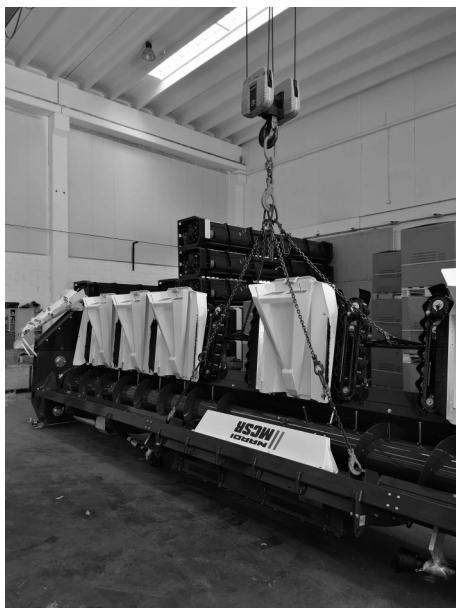
FIG. 01 - AGGANCIARE 4 TIRI CATENE NEGLI APPOSITI OCCHIELLI DI SOLLEVAMENTO. VERIFICARE LA PORTATA DEI TIRI CATENA CON IL PESO DELLA BARRA. FIG. 01 - HOOK 4 CHAINS ON THE LIFTING HOLES. CHECK THE LOAD CAPACITY OF THE CHAINS WITH THE WEIGHT OF THE HEADER.
