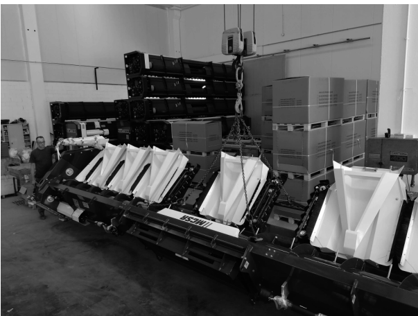
FIG. 02 - 05 - INIZIARE IL RIBALTAMENTO SOLLEVANDO IL GANCIO DELLA GRU IN MODO LENTO E CONTINUO E MANTENENDO IL PIU' POSSIBILE SULLA VERTICALE.
