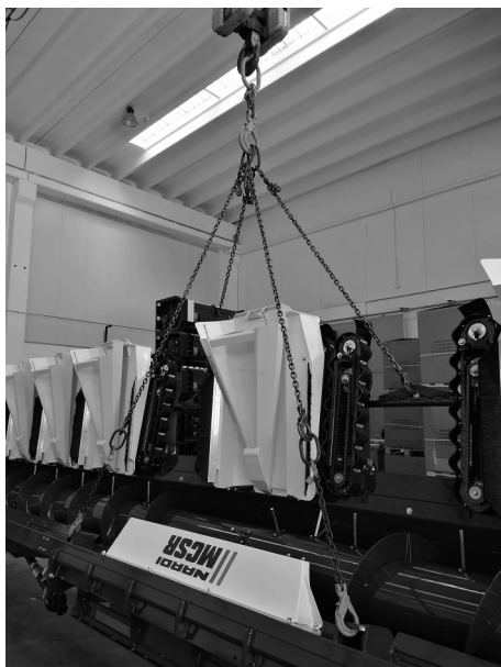
FIG. 02 - REGOLARE LA LUNGHEZZA DELLE CATENE IN MODO TALE DA POSIZIONARE IL GANCIO DELLA GRU IL PIU' VICINO AL BARICENTRO. FIG. 02 - ADJUST THE LENGTH OF THE CHAINS SO AS TO POSITION THE CRANE HOOK CLOSER TO THE CENTER OF GRAVITY.
