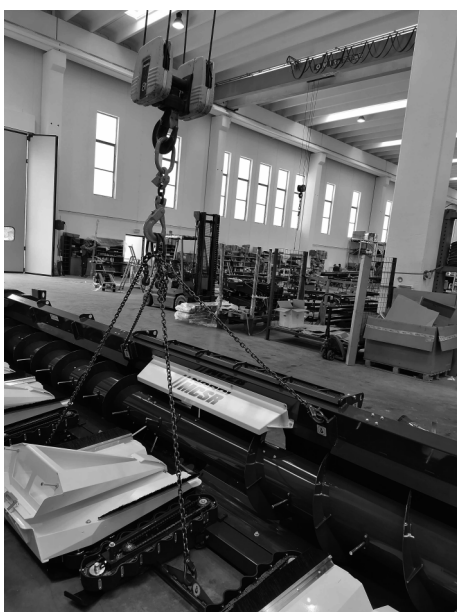
FIG. 03 - REGOLARE LA LUNGHEZZA DELLE CATENE IN MODO TALE DA POSIZIONARE IL GANCIO DELLA GRU IL PIU' VICINO AL BARICENTRO.
